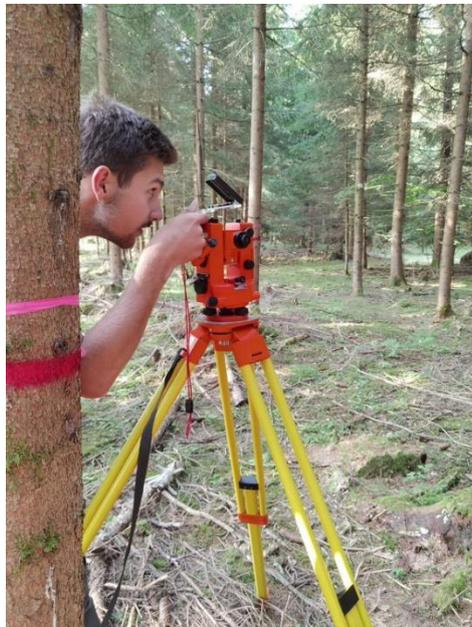
Abbildung 15 Messen mit Theodolit und Bussole
