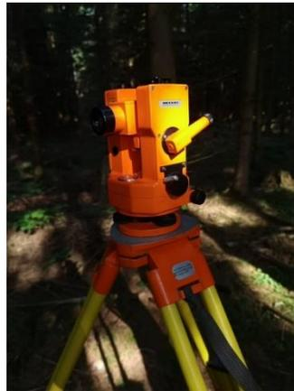
*Abbildung 9 Theodolit mit Stativ*
