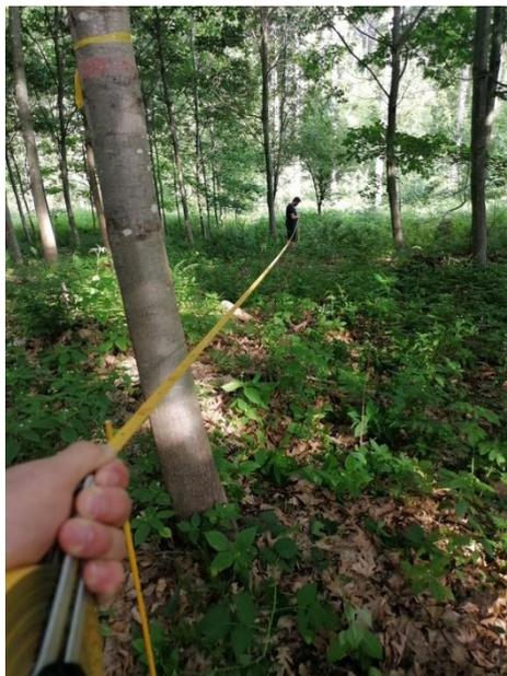
Abbildung 16 Messen mit Stahlmaßband
