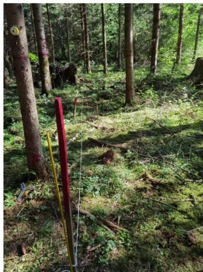
Abbildung 19 Schnur zum Einmessen ins Koordinatensystem
