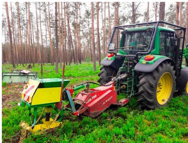
Abbildung 17 Kleinschlepper mit Anbaugerätkombination Streifenfräse/Sämaschine Quelle: (Rakel, 2022)
