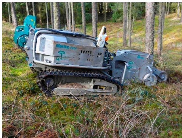
Abbildung 18 Kleinraupe mit Fräs-Sämaschine Quelle: (Rakel, 2022)
